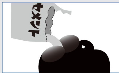
(2) MT 処理土をセメントや石灰等で改良する
